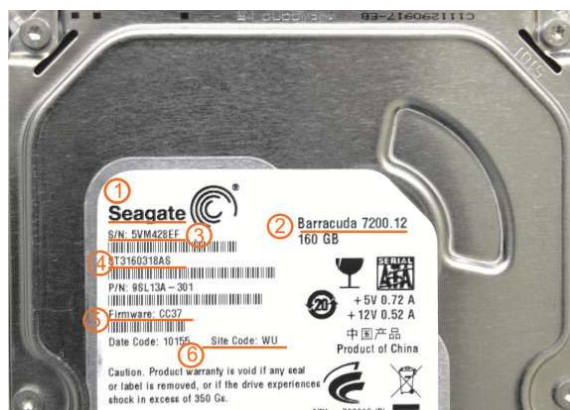
1 – производитель – Seagate; 2 – наименование семейства – Barracuda 7200.12; 3 – серийный номер – 5VM428EF; 4 – наименование модели – ST3160318AS; 5 – версия FW – CC37; 6 – Site code (код места производства) – WU.
